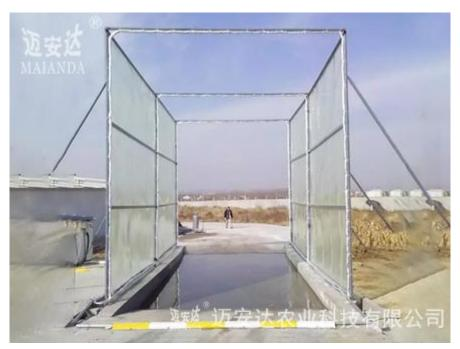
元旦假期马上就要到了,时光如梭,过的太快了,新的一年又要来临,为了回报 老客户,迎接新客户,车辆消毒设备生产厂家,米孚环保科技有限公司特退出元 旦大欢送,迈安达农业科技有限公司生产的所有喷雾产品,均以出厂价最低售出, 并且还有超值大礼相送,抢到就是赚到,赶快来预定吧! 迈安达车辆消毒车备是针对于进出的车辆全身进行消毒处理,消毒通道两侧安装几根立柱,立柱上安装的是尼龙管,尼龙管上安装扇形喷头,扇形喷头流量大,造雾快速,每个扇形喷头的流量是 1l/min,尼龙管的外径是 9.52mm,尼龙管的内径是 4~5mm,一根尼龙管通过的水量是 12kg。
